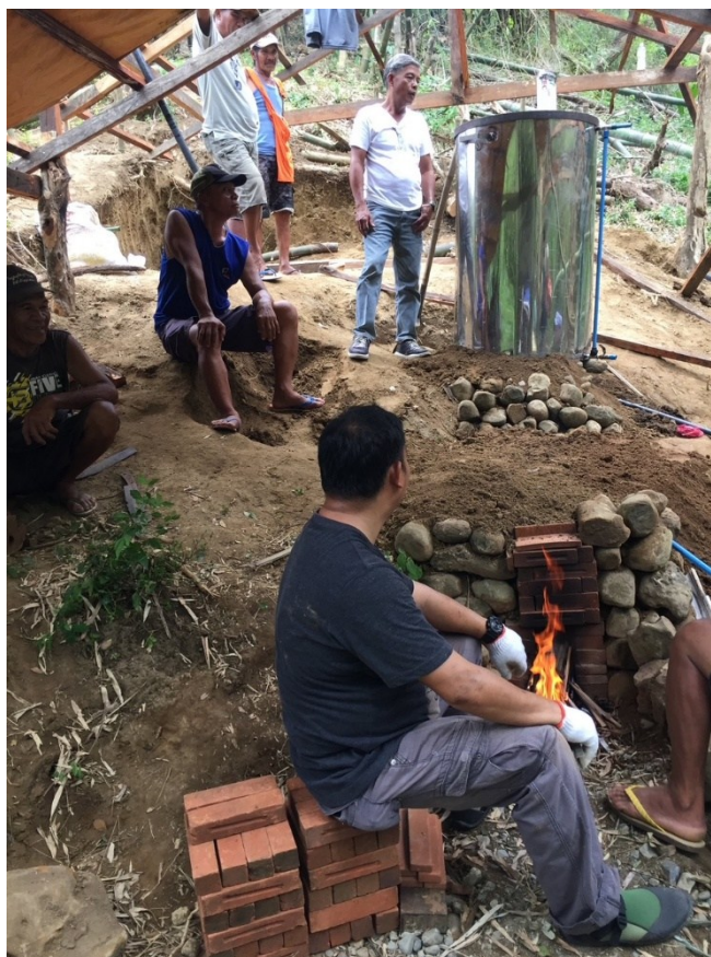
炭・木酢製造のための窯に火入れした様子
